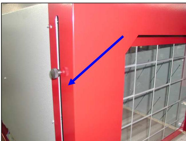
Dans la phase d'ouverture, la porte sera portée à la position déterminée sur le bouton. L'ajustement est effectué indépendamment pour chaque port.
