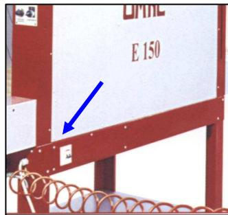
La présence de tension sur le panneau de contrôle est mis en évidence par l'allumage de la LED "POWER " vert.
