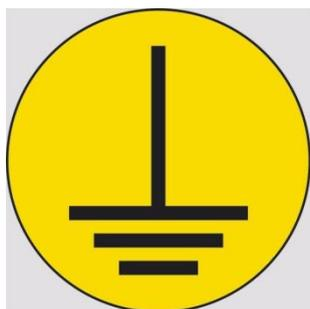
Ce symbole indique que la partie métallique sur lequel elle est apposée est relié électroniquement au fil de protection (jaune / vert de terre) et qu'il est essentiel, pour la mise à la terre de la machine, ne pas retirer ce fil.
