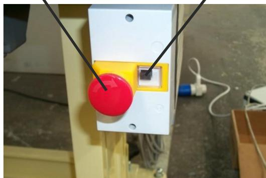
**AVERTISSEMENT:** lorsque l'interrupteur éteint la machine en utilisant le bouton de champignons, il restera verrouillé, pour allumer la machine, il doit être déverrouillé: tourner dans le sens horaire.
