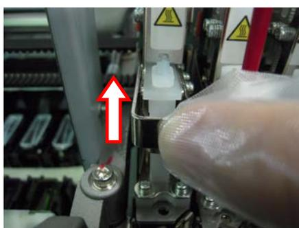
(18) Installer la nouvelle tête d'impression dans l'imprimante. Ajuster la rainure en forme de V dans la broche à positionner.
