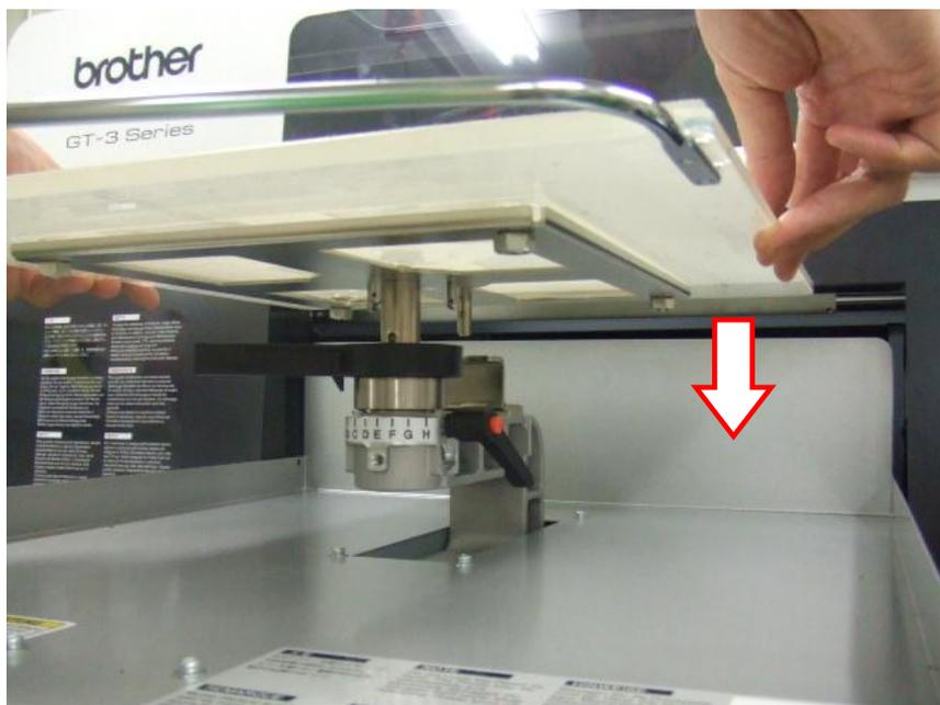
(2) Resserrer fermement le levier de fixation du plateau.
