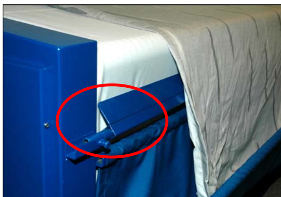
Figure 12 Bande de guidage contre housse de repassage
