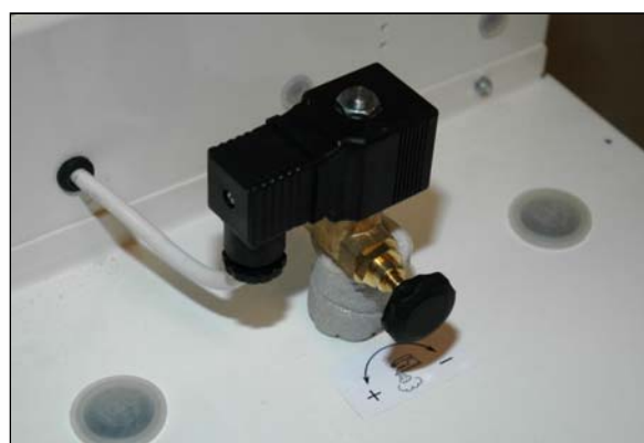
Figure 11 Vis de réglage pour vapeur
