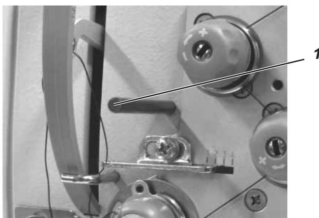
La goupille d'arrêt 1 nécessaire pour l'ajustage de la machine est livrée en série avec chaque machine. Elle se trouve dans les accessoires de la machine et peut facilement être fixée en dessous du carter d'huile.
