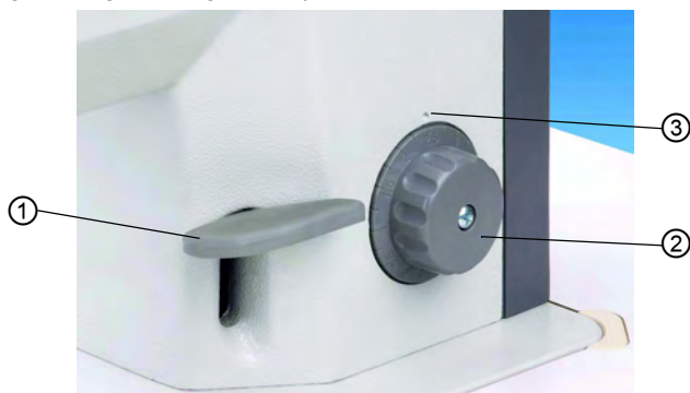
Fig. 18: Régler la longueur de point
