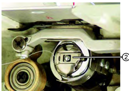
Fig. 10: Remplacer la canette du fil de crochet
