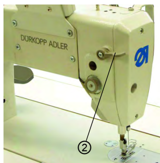
(2) - Levier en haut: Pied presseur bloqué en position
