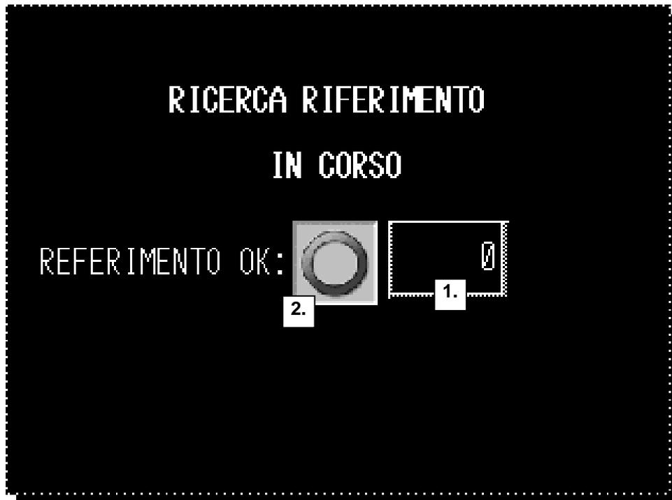
Ad inizio giornata e dopo aver tolto corrente elettrica alla macchina è necessario riportare la testa di cucitura al suo punto di partenza. Quando viene premuto il tasto AUTO oppure MANUALE la ricerca del punto di partenza e di riferimento viene effettuata automaticamente e lo schermo presenta la seguente finestra. La schermata scompare quando il punto di riferimento è stato raggiunto e la macchina è pronta per la lavorazione.
