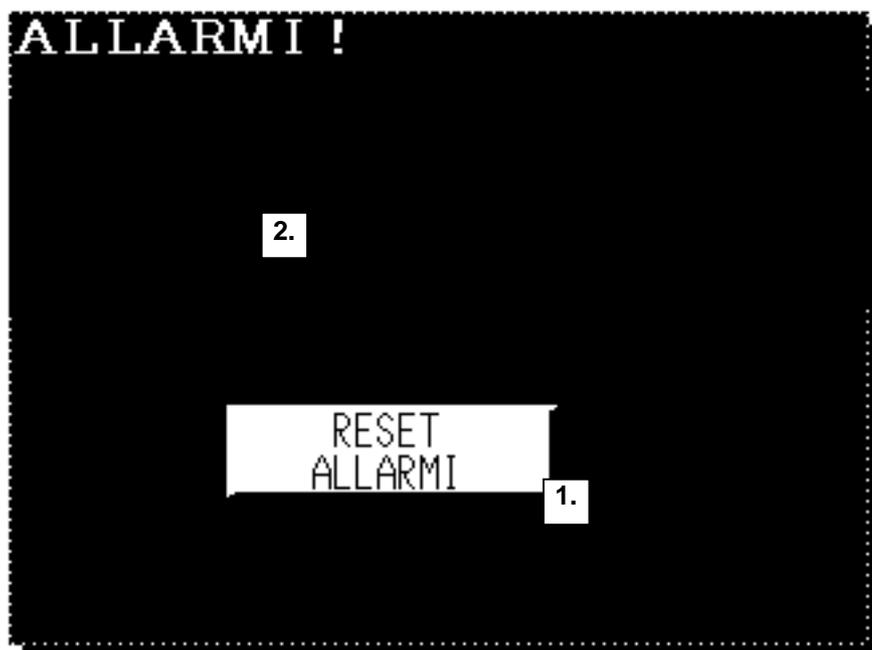
In questa finestra vengono visualizzati tutti gli allarmi attivi. La finestra appare sullo schermo soltanto quando un allarme è attivo. La causa dell'allarme deve essere risolta prima di poter riarmare il sistema, es: rottura filo: occorre sistemare il filo prima di poter premere reset allarmi, stop emergenza: occorre riarmare il pulsante di emergenza prima di poter premere reset allarmi.
