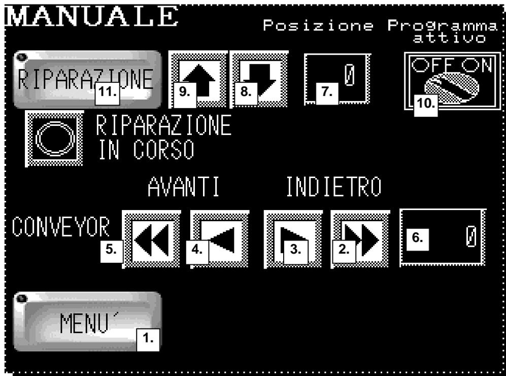
Questo menu permette la movimentazione manuale. E' possibile passare ad una posizione di cucitura avanti o indietro (es: nel caso di cuciture multiple su un solo articolo) per effettuare una riparazione.
