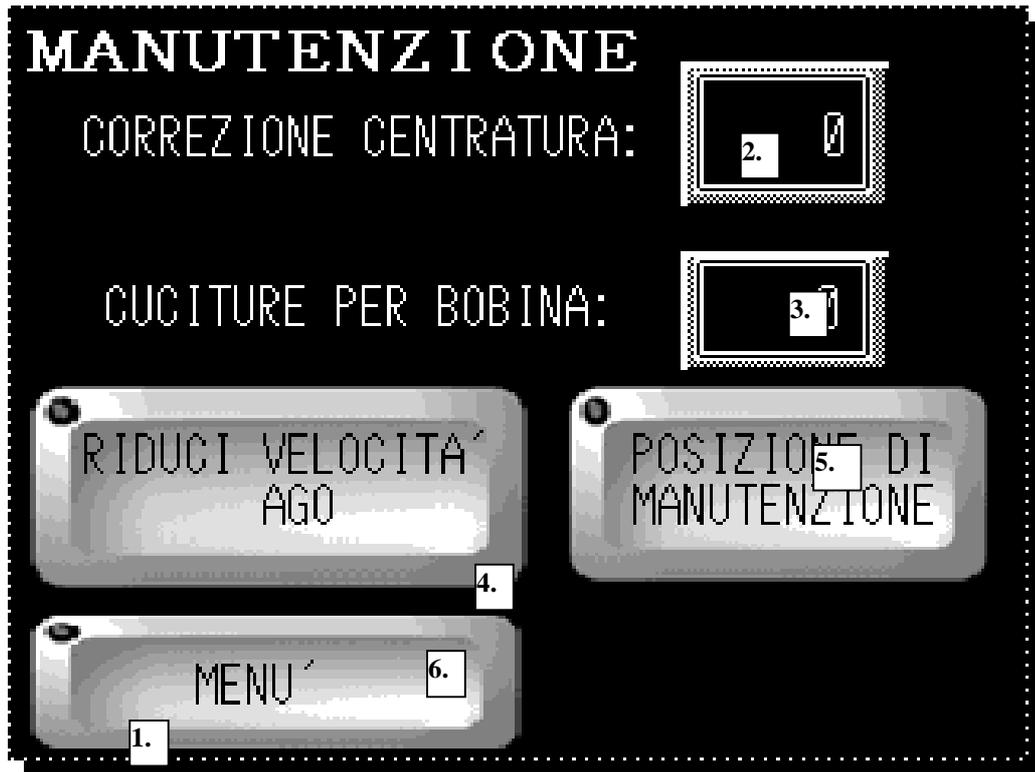
In questo menù si può inserire il numero di cuciture possibili con una bobina di filo. E' anche possibile ridurre la velocità dell'ago per materiali particolarmente difficili. In particolar modo, in questo menù si porta la testa di cucitura in avanti verso l'operatore per la varie operazioni di cambio spola, ago, filo nell'ago, ecc ecc
