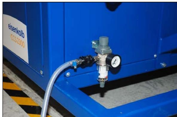
Figure 31 Unité d'alimentation d'air comprimé
