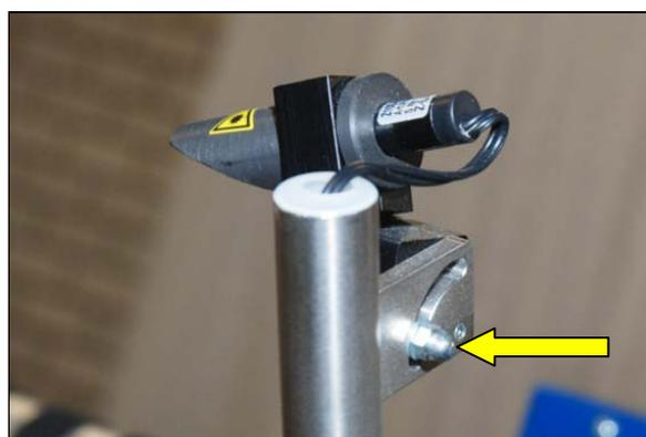
Figure 32 Possibilité de réglage pour position de la ligne laser
