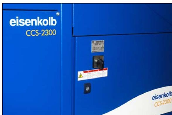
Figure 18 Interrupteur principal
