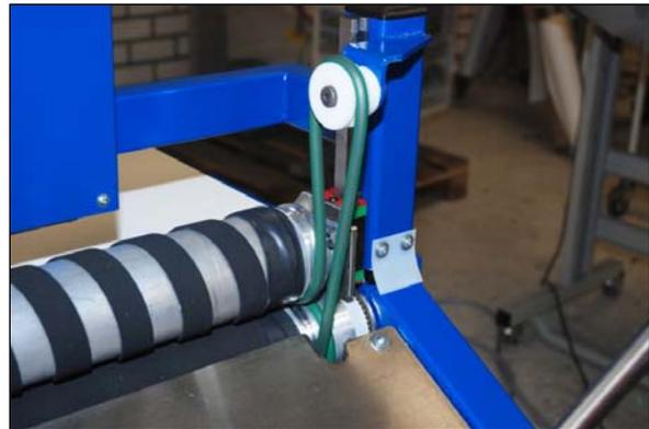
Figure 30 Un des cylindres et courroies à nettoyer
