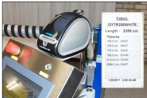
Figure 16 Imprimante d'étiquettes avec exemple
