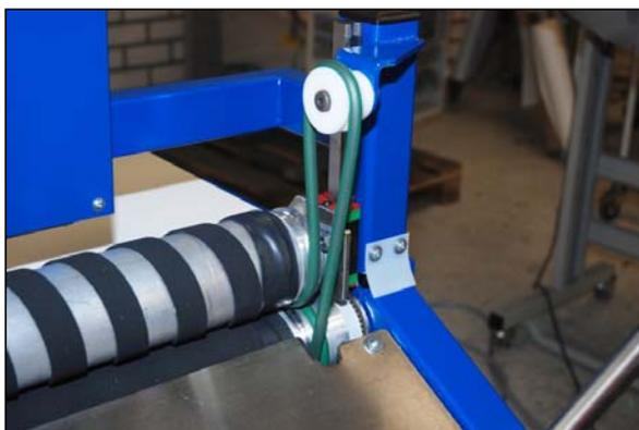
Figure 3 Endroits de coincement près du cylindre d'alimentation
