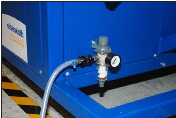
Figure 17 Alimentation d'air comprimé de la CCS-2300
