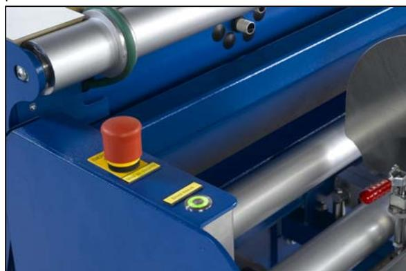
Figure 15 Eléments de commande près de la position de la pose du rouleau
