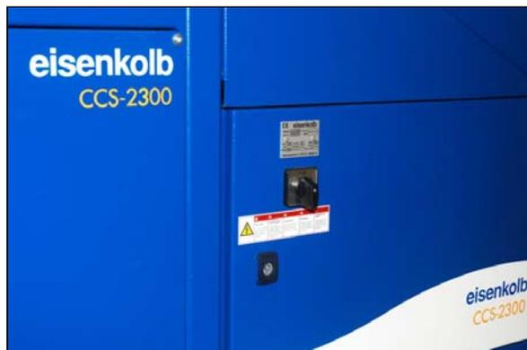
Figure 14 Interrupteur principal
