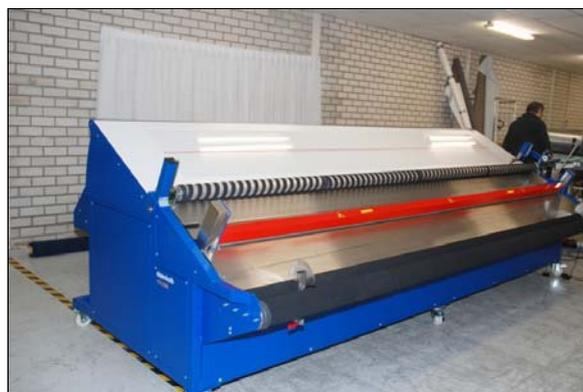
Figure 5 La table d'inspection reste sous pression après l'arrêt de la machine
