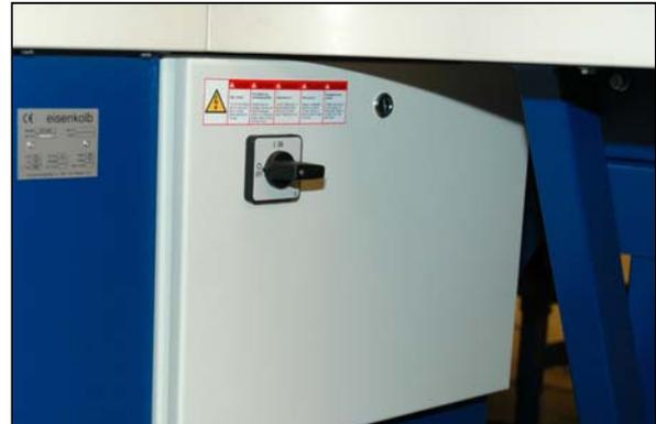
Figure 22 Interrupteur principal de la CCP-2300
