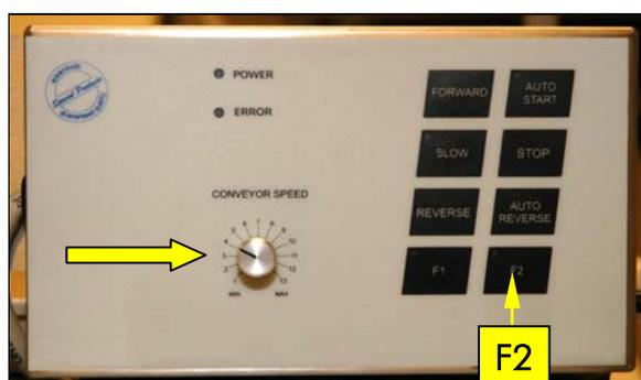
Figure 31 Réglage de la vitesse de la table de transport et de la fin de tissu
