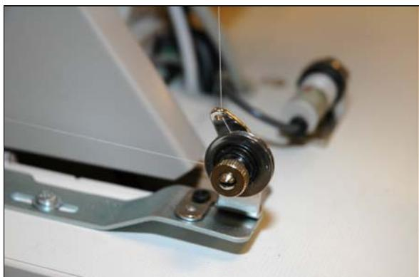
Figure 33 Dispositif de réglage de tension pour l'embobinage de bobines
