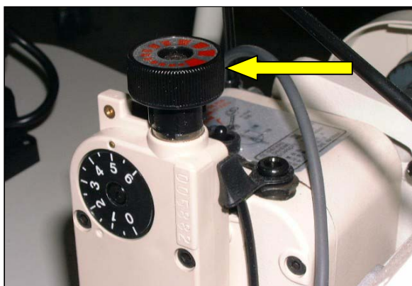
Figure 15 Réglage de la vitesse de la table de transport
