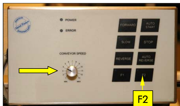
Figure 18 Réglage de la vitesse de la table de transport et fin du tissu (F2)
