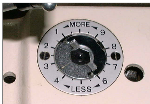
Figure 16 Disque de réglage de la profondeur de l'aiguille
