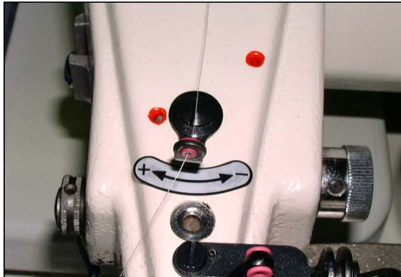
Figure 11 Réglage de la tension du fil
