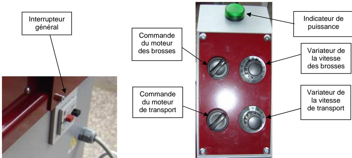
La présence de tension sur le panneau de contrôle est mis en évidence par l'éclairage d'un bouton vert clair indicateur spécial, tourner les interrupteurs en position "1" sera lancé quel que soit le moteur de la brosse et celle des transports.
