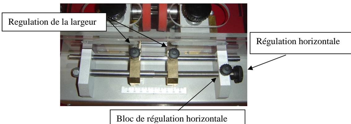
Pour ajuster la largeur que vous avez, desserrer l'un des deux boutons de cuivre sur les blocs, choisir la largeur et le raccord.
