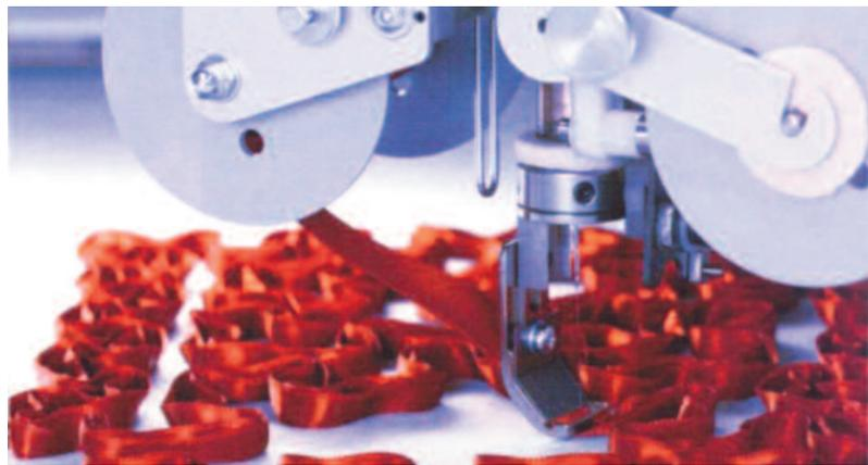
Le K Head est une tête spéciale pour la broderie en « point mousse ». Un changement de couleur automatique 6 couleurs de fil permet de multiplier les combinaisons d'effets. Il est possible de combiner les deux aspects.
