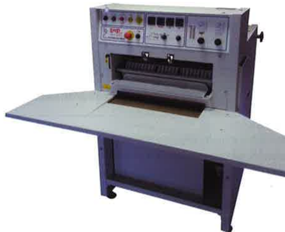
PR5/N: machine pour le thermocollage des cols et poignets de chemises.
