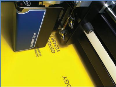
En option, système à jet d'encre d'identification des pièces
