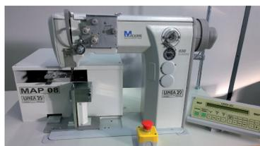
Toujours développée avec Linèa 20, la machine MAP 08 permet de fermer les passants de ceinture ou de bracelet de montre.
