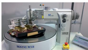
Ces machines sont fabriquées sur une base Durkopp Adler, machine fiable et maîtrisée, à l'encontre de la technologie de machine à tête tournante, plus complexe en termes de
