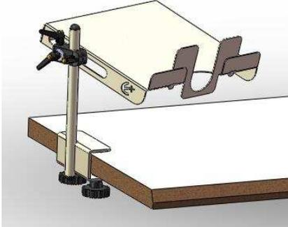
**Tablette réglable en 3 dimensions** pour mise à portée de main des pièces à assembler .
