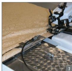
1. Point de chaînette invisible, 1 fil, avec entraînement inférieur par puller
