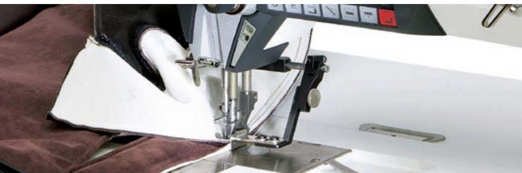
Schließnähte/Verbindungsnahte bei Vormontagearbeiten in der Automobilindustrie
