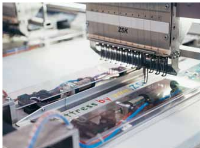
Fig: Clamping Frame of ROLL2ROLL
