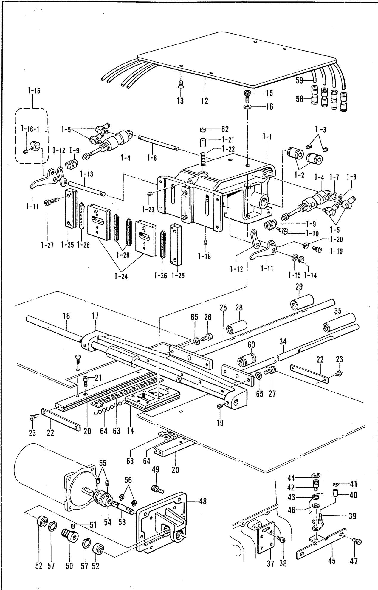
Mécanisme de l'entraînement (1)/Mecanismo de la alimentación (1)
