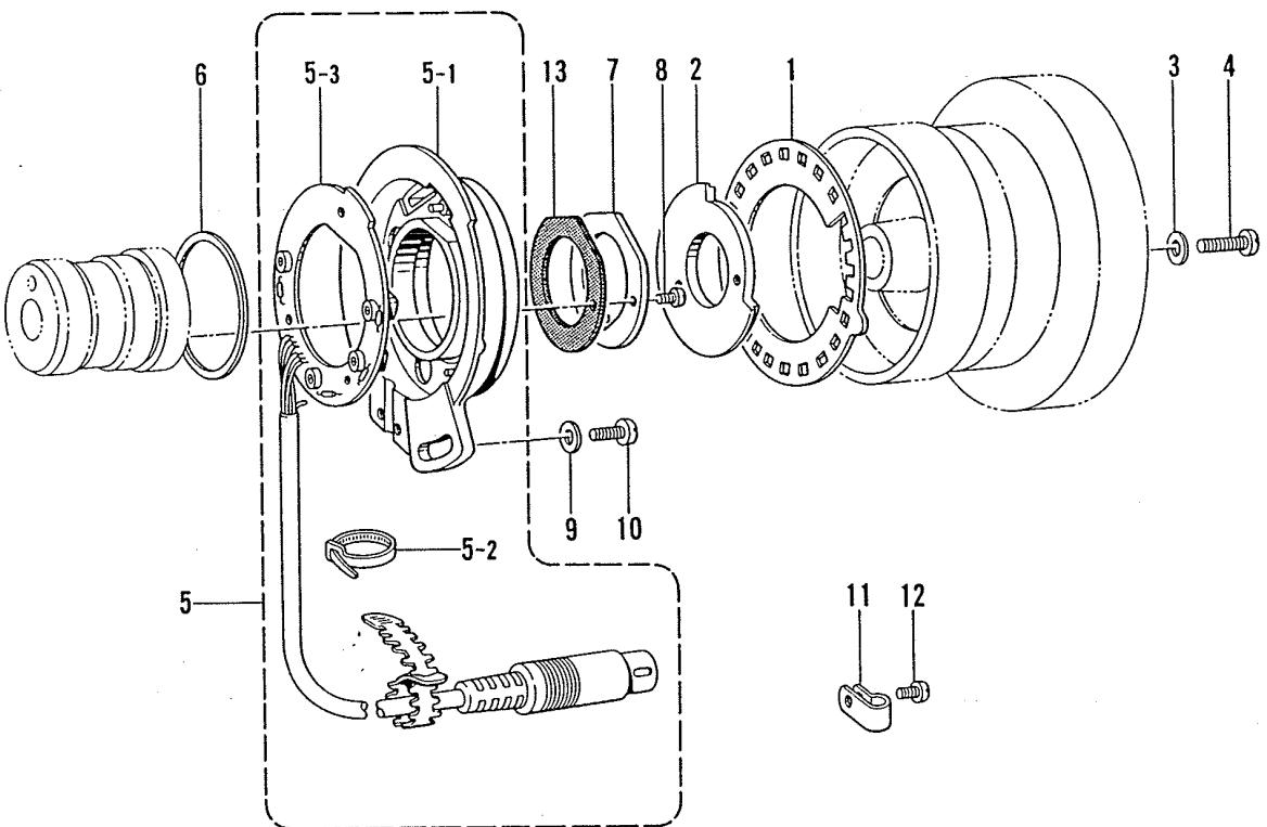
S. 踏板関係 /Foot switch pedal mechanism/Fußbetätigung/
