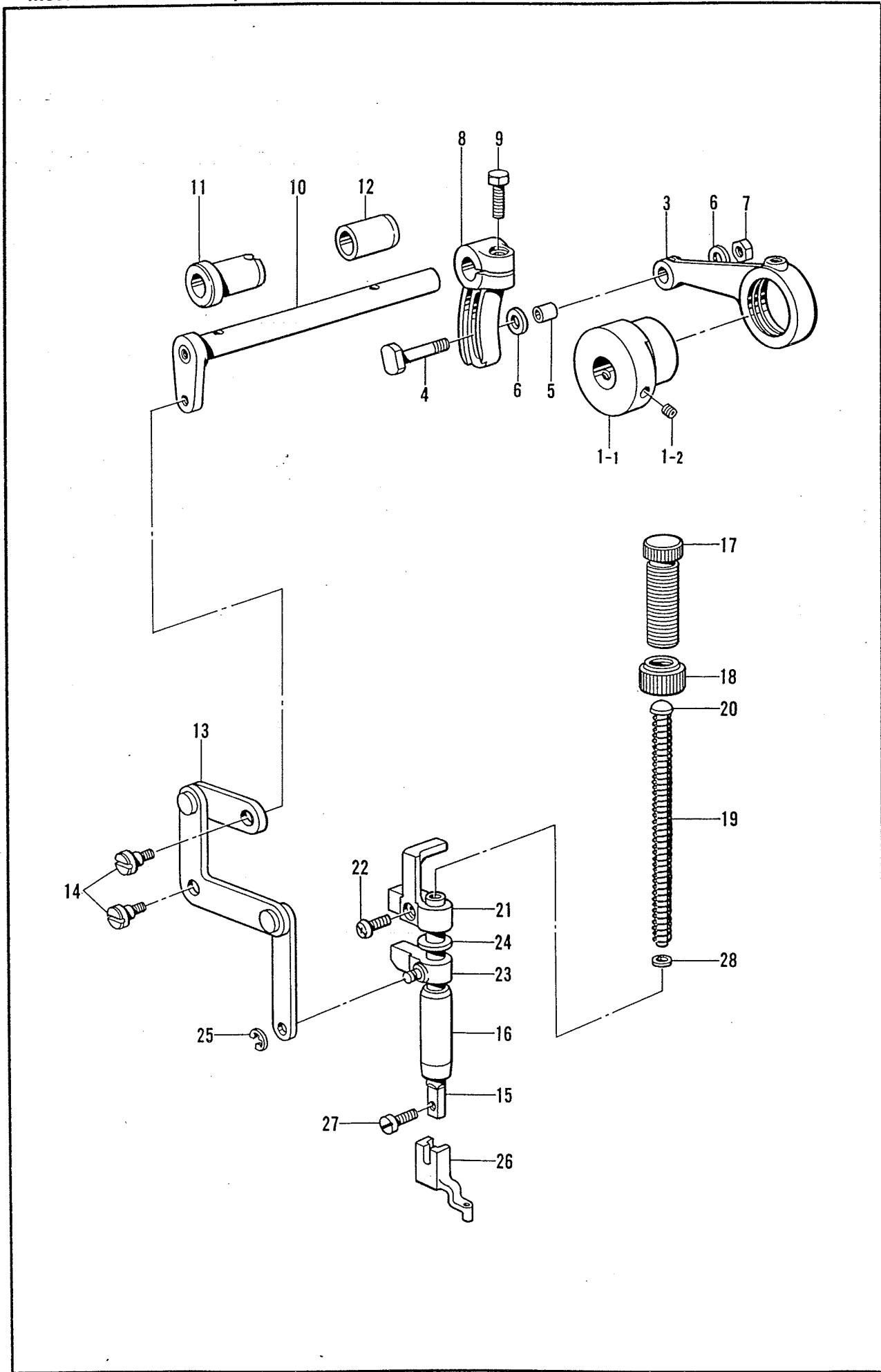
II. ワーククランプ機械 / WORK Clamp Lifter mechanism / Stahlarbeitsvorrichtung /
