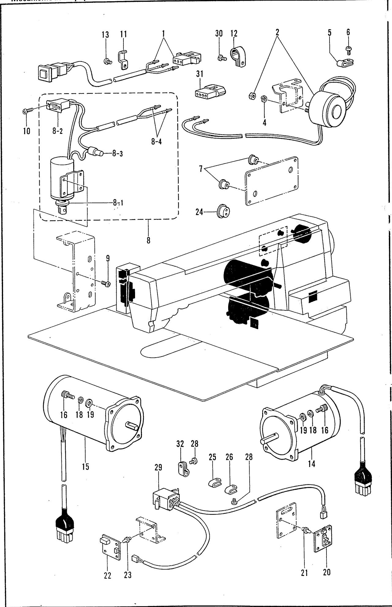
Mécanisme de l'équipement en alimentation électrique/Mecanismo del equipo de alimentación de corriente
