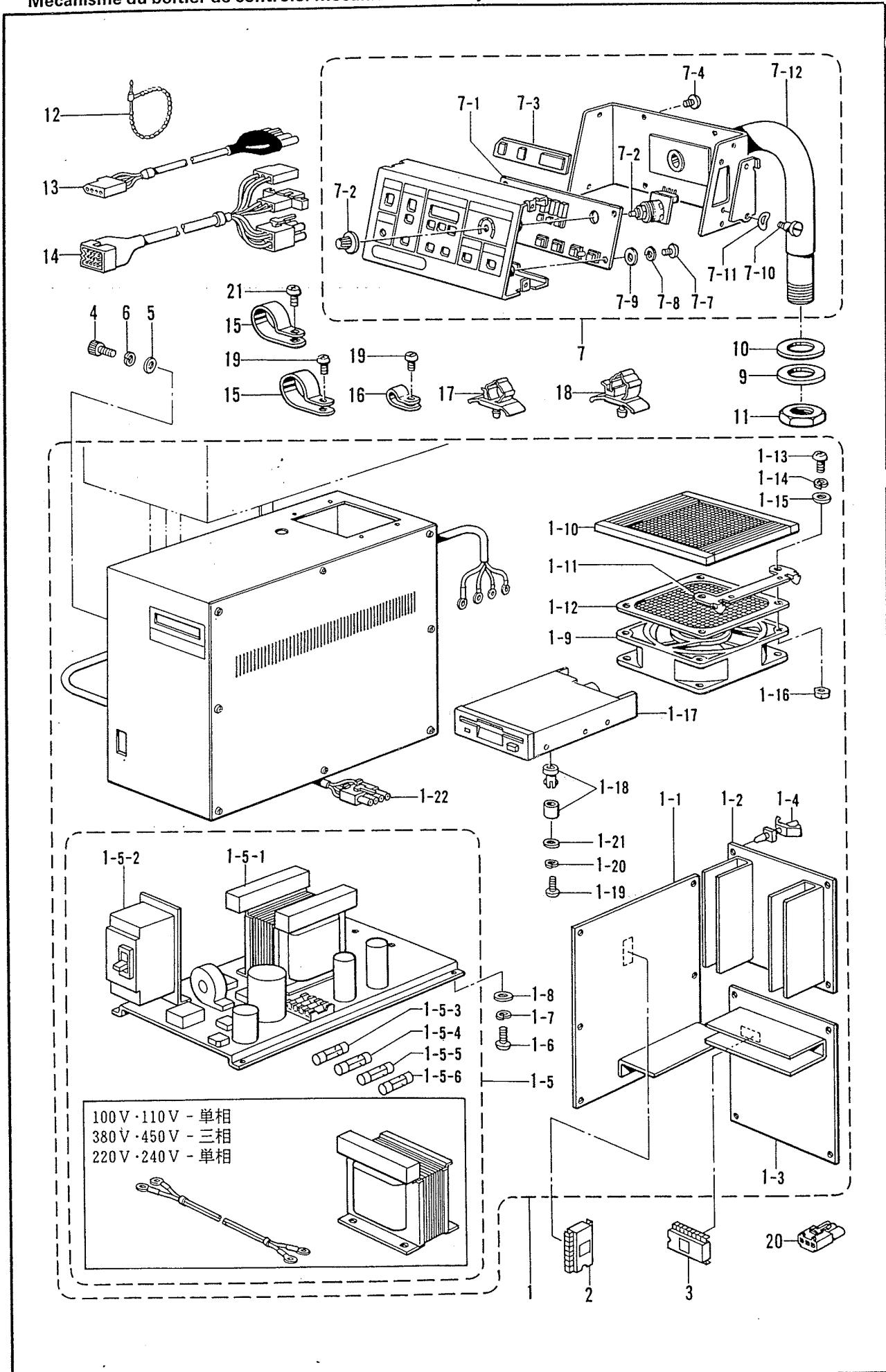
1. コントロールボックス関係 / Control box mechanism / Schaltkasten /
