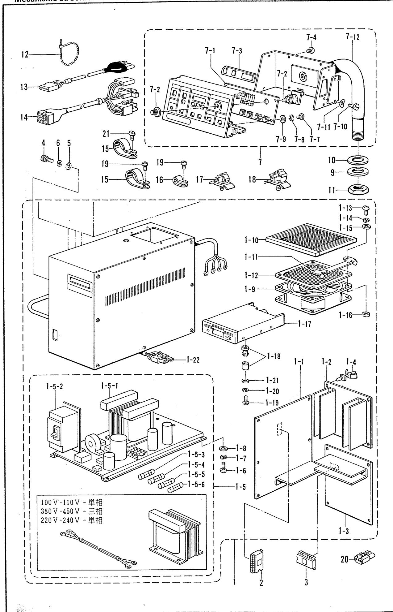
T. コントロールボックス関係/Control box mechanism/Schaltkasten/
