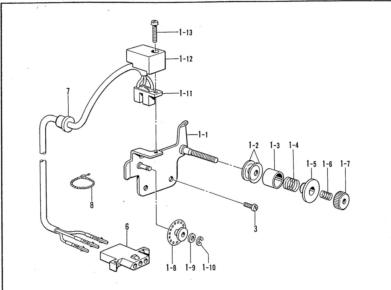
N. 糸拭イ関係 / Thread wiper mechanism / Fadenwischvorrichtung /
