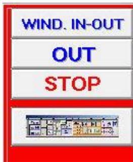
Ces boutons nous permettent de faire un test pour voir le programme avec WIND. IN-OUT, charge le programme sur la machine; avec OUT via un port USB; ou arrêter un programme de chargement avec STOP. Les deux derniers boutons permettent d'ouvrir la fenêtre de boutons d'options de couture spécial ou sélectionnez un angle entre trois points.
