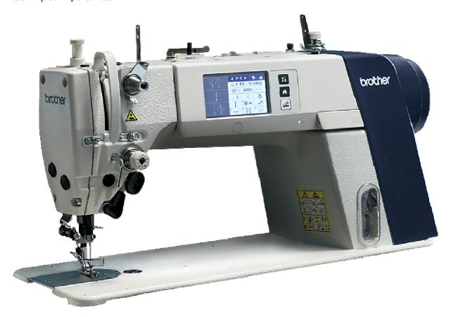
Mouvement de la griffe entrainé par un moteur pas à pas : c'est le moteur, commandé électroniquement, qui change la direction de l'alimentation, supprimant tout bruit en marche arrière (la bonne comparaison entre le bruit de la Nexio et celui des autres machines, serait celle d'un véhicule à moteur thermique comparé à un véhicule électrique).
